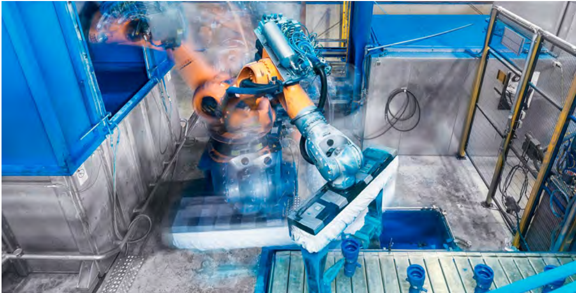
Beschichtungsroboter am Standort Hall in Tirol im Einsatz
