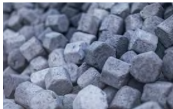
Siliziumkarbid zur Anhebung des Siliziumgehalts im Eisen
