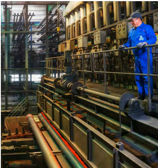
Glühofen zur Verbesserung der Werkstoffeigenschaften
