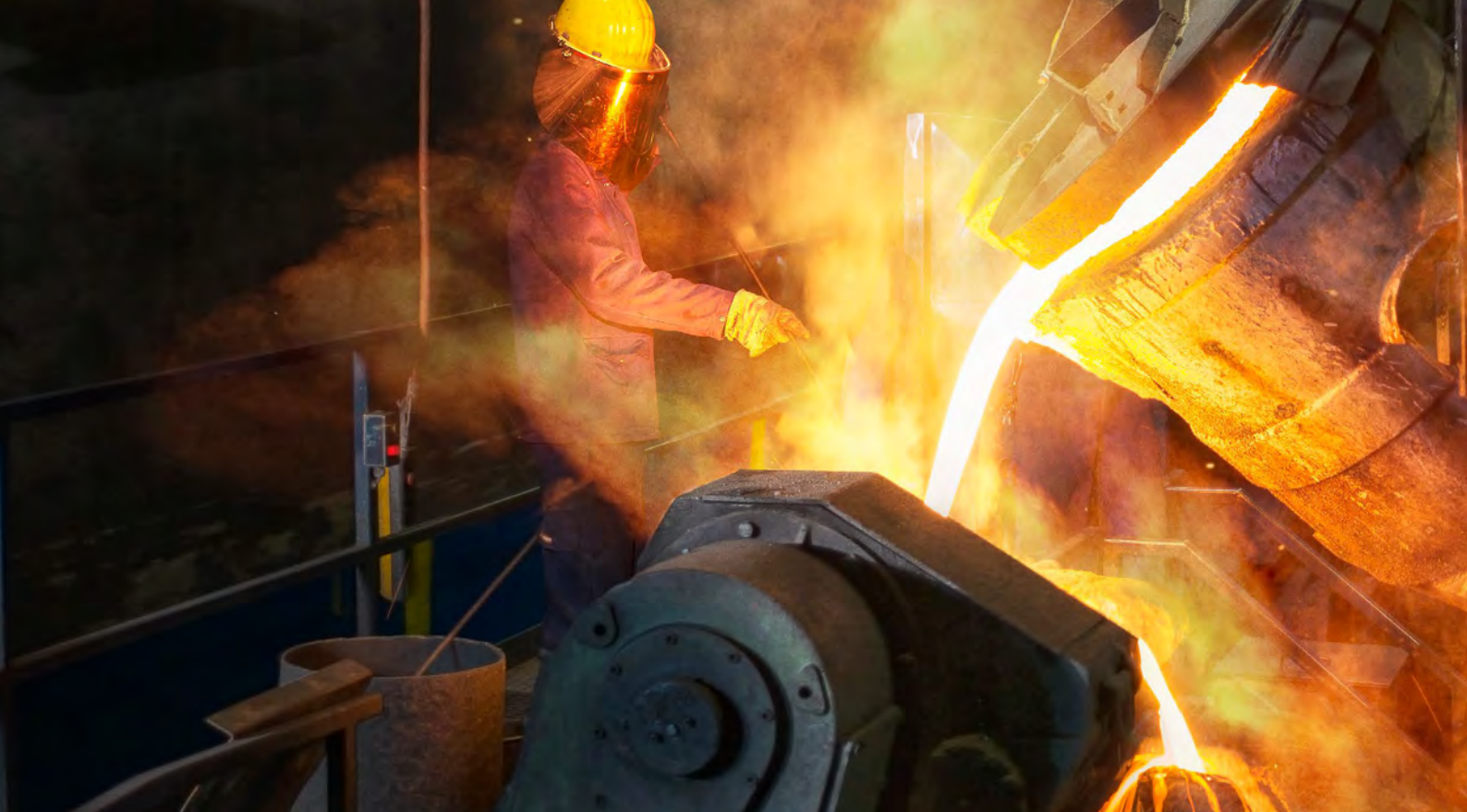
Befüllung der Schleudergussmaschine
